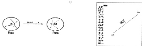
Fig 1 디지털 디자인은 입력값집합과 출력값집합의 알고리즘 관계인 연산 가능 함수를 활용한다. 건축 디자인에서 두 집합은 주로 점, 선, 면 등의 기하학적 개체로 정의된다. 그리고 그 관계는 연속적인 기하학적 연산에 의해 형성된다. Digital design is conscious utilisation of computable functions, an algorithmic relationship between an input set and an output set. In most applications in architecture these two sets are defined by geometric entities like points, NURBS curves or surfaces and the relationship is given by a sequence of geometric operations.
